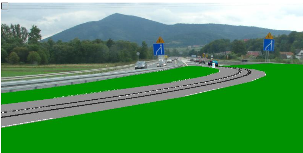
Rysunek 10. Przebieg symulacji na wybranym odcinku drogi, prędkość V=115\text{km/h} z widocznymi śladami zarzucania.
