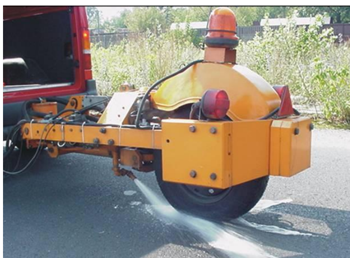
Fot. 11 Przyczepa dynamometryczna SRT-3 podczas wykonywania pomiaru
